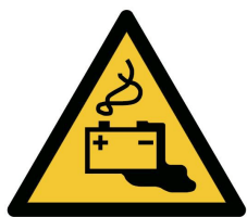
W026 – Danger batterie en charge
