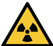
W003 - Danger matières radioactives ou radio ionisantes
