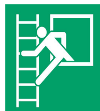
E016 – Fenêtre de secours avec échelle de secours
