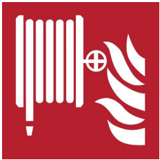
F002 – robinet d'incendie armé
