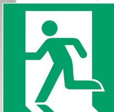
E001 – Sortie de secours à gauche
