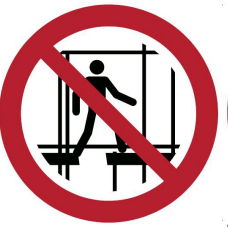
P025 - Interdiction d'utiliser un échafaudage inc.
