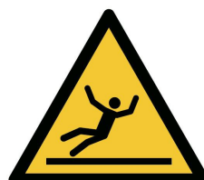
W011 – Danger surface glissante
