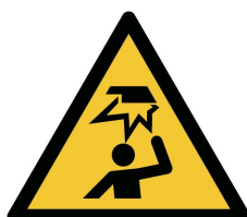
W020 – Danger obstacle en hauteur
