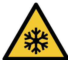
W010 – Danger basses températures conditions de gel
